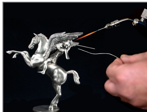
Microsoudure de précision d'une figurine en étain (fournie par Ballantynes Of Walkerburn)
