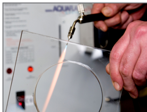
Polissage à la flamme de bord acrylique.
